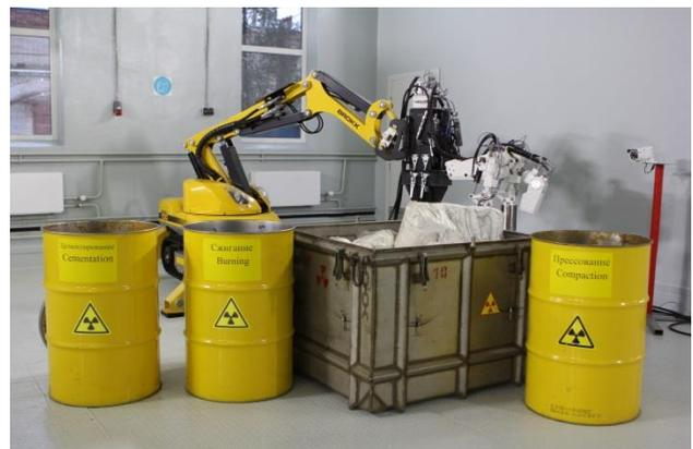
Технологические операции с источниками ионизирующего излучения производятся дистанционно в радиационно-защитных камерах, оборудованных манипуляторами.
