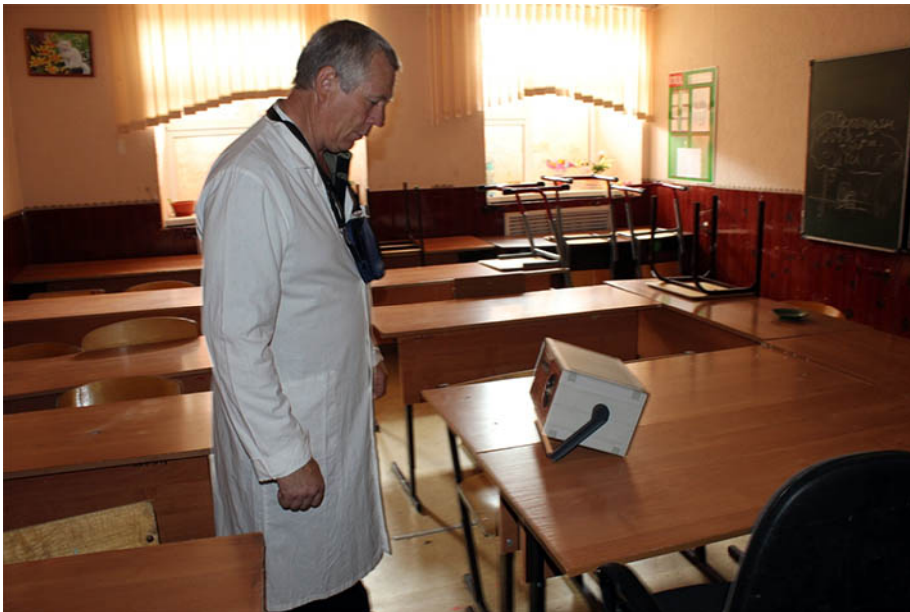
Рис. 5. Измерение радона-222 в кабинетах МОУ «Большесальская школа № 8».
