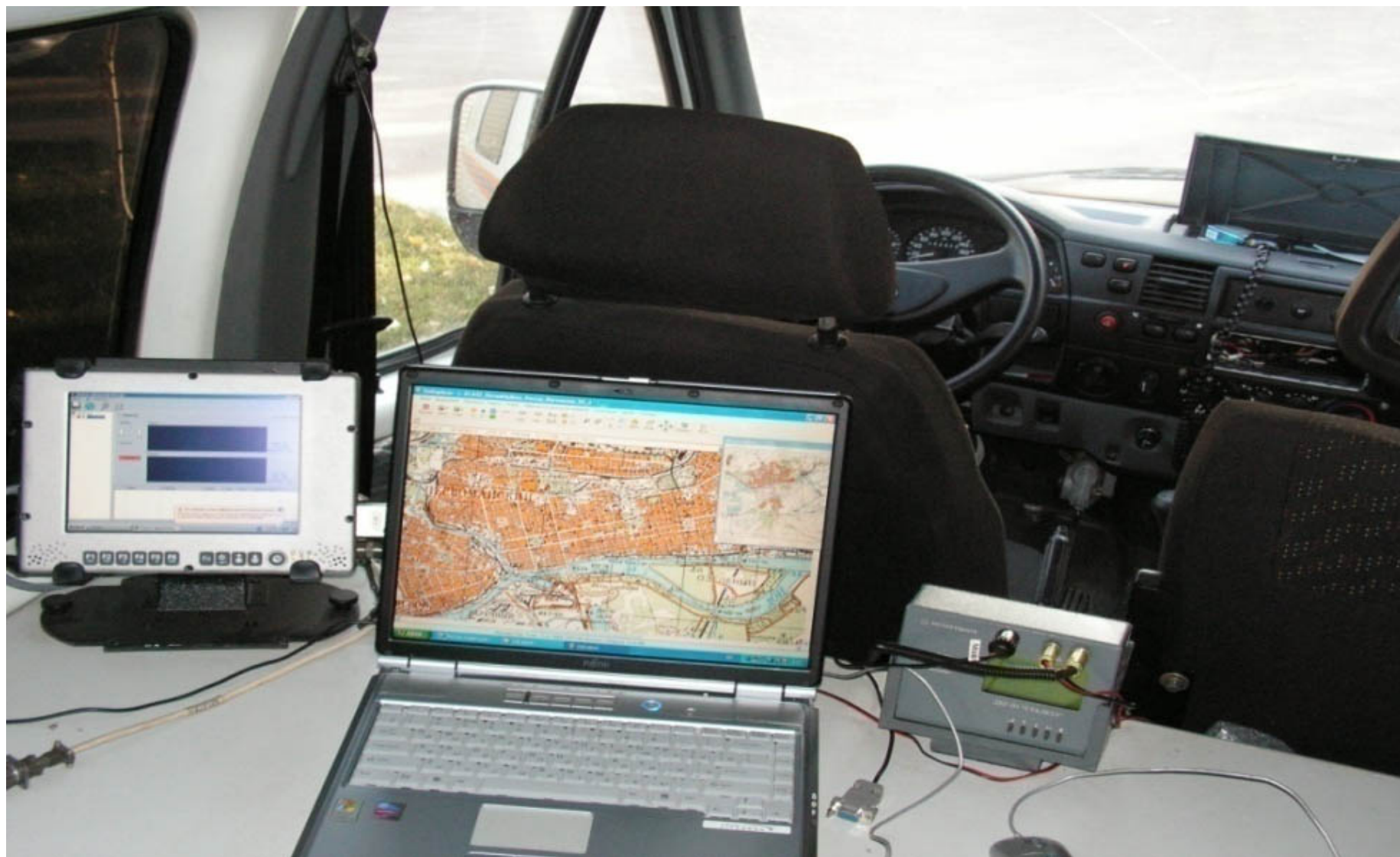
Рис. 1. Подготовка к проведению авто-гамма-съёмки улиц села Большие Салы
