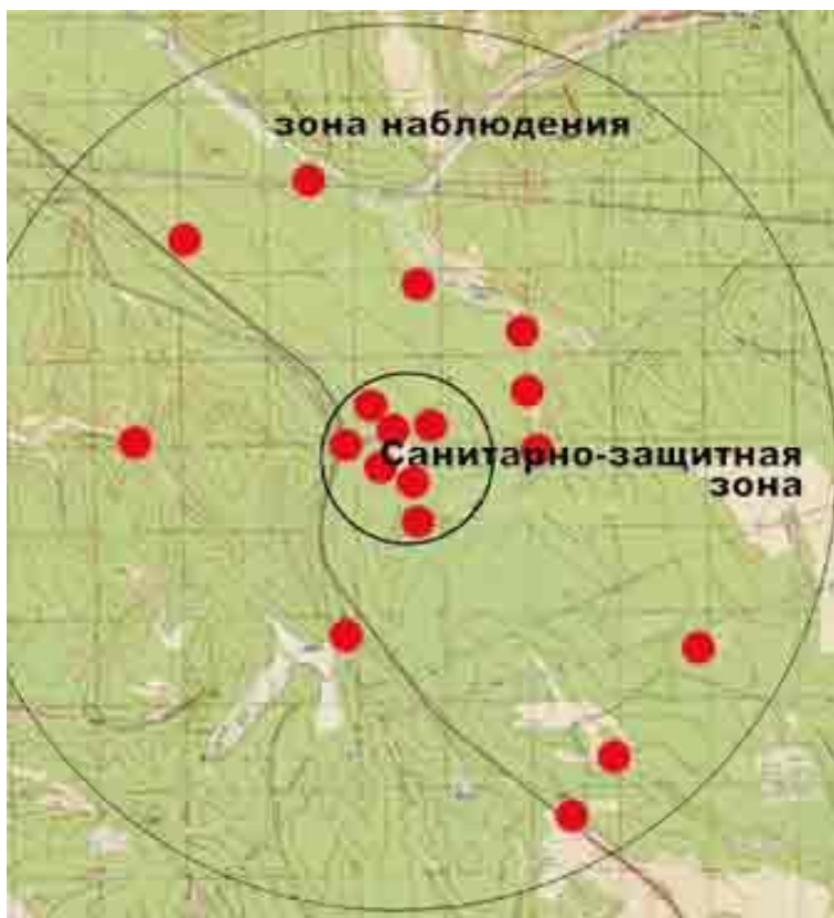
Расположение точек радиационного контроля в санитарно-защитной зоне и зоне наблюдения пункта хранения радиоактивных отходов
