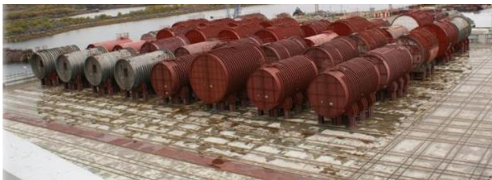
Реакторные отсеки на длительном хранении
