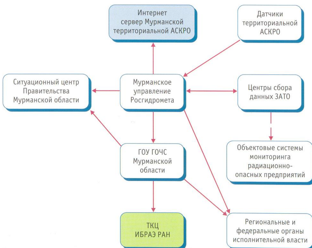
Схема потоков данных территориальной АСКРО
