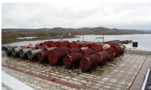
**Фото 4.** Реакторные отсеки на длительном хранении
