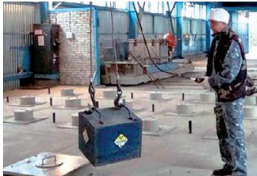
Участок бесконтейнерного хранения отработавших источников ионизирующего излучения
