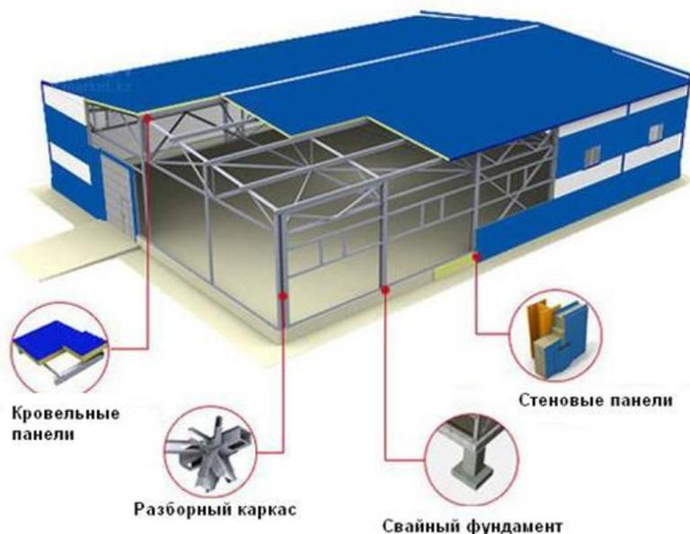
Рис. 2.4.3.1– Ангар каркасный быстровозводимый сборно-разборный (АКБСР)
