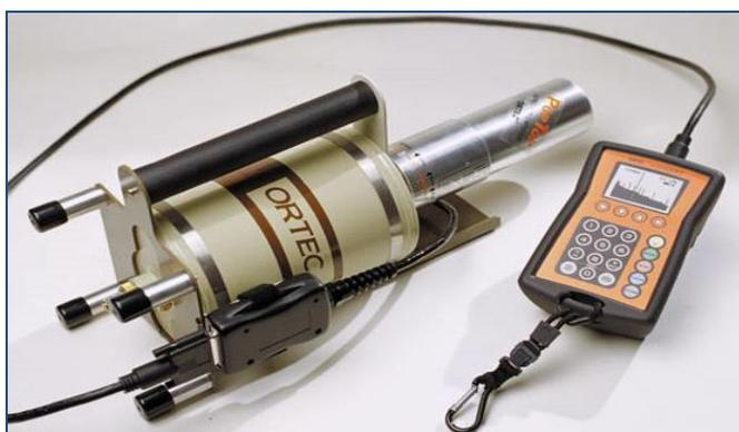
Рисунок 4.13.2. – Спектрометр - радиометр цифровой портативный многоканальный гамма и рентгеновского излучения digiDART
