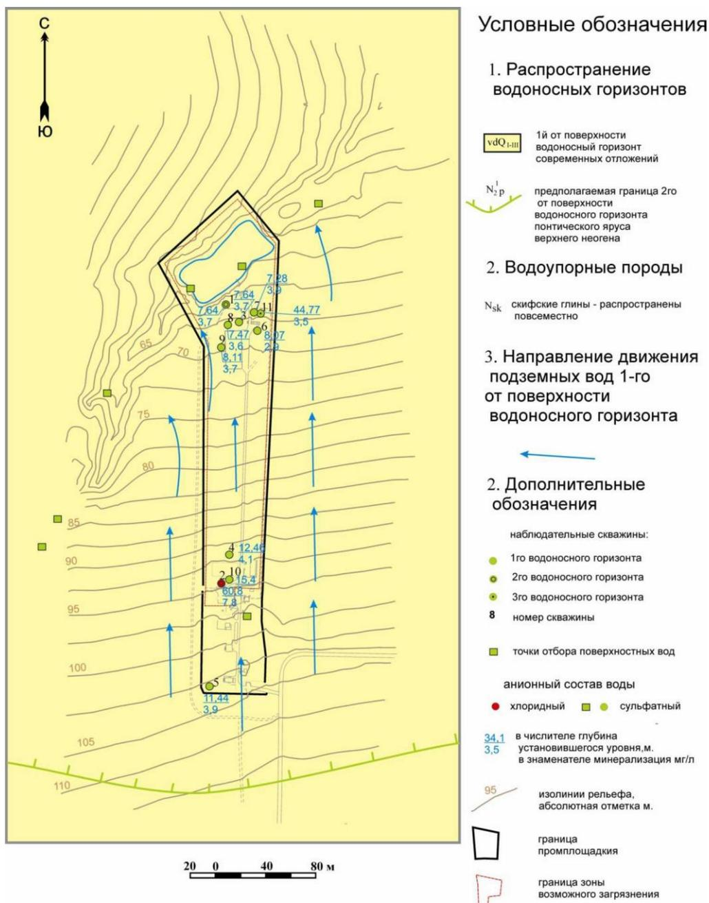
Рисунок 4.5.5.1 - Гидрогеологическая схема ПХРО филиала «Южный территориальный округ» ФГУП «ФЭО»
