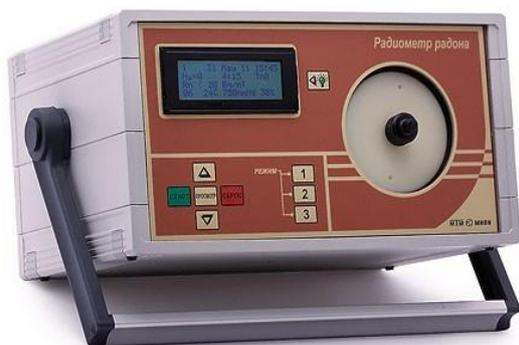
Рисунок 4.13.4. – Радиометр радона РРА-01М-
